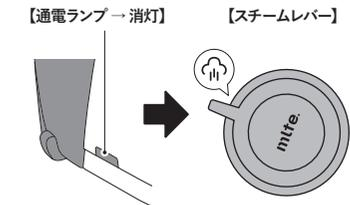
※スチームは、必ず「HIGH」の間で使用して下さい。「LOW」「MEDIUM」で使用すると水漏れしますので、絶対に使用しないで下さい。
