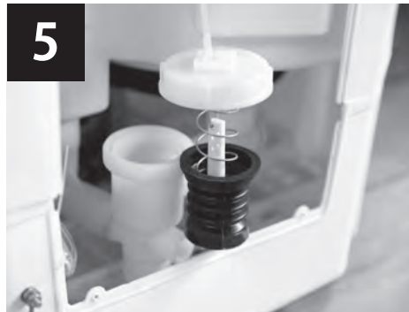
キャップ、バネ、ゴムストッパーを引き上げる。
