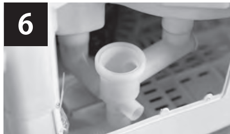
パイプの内部にゴミが詰まっている場合はピンセットなどで取り除いて下さい。 ※作業後は水漏れしないように、キャップを確実にしめて下さい。
