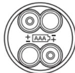
3.電池キャップをマークに合わせて取り付けして下さい。
